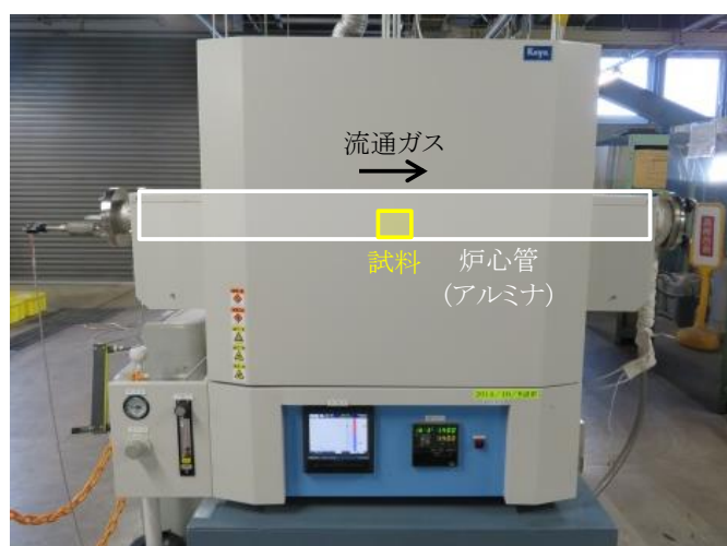
設備の外観および構成
