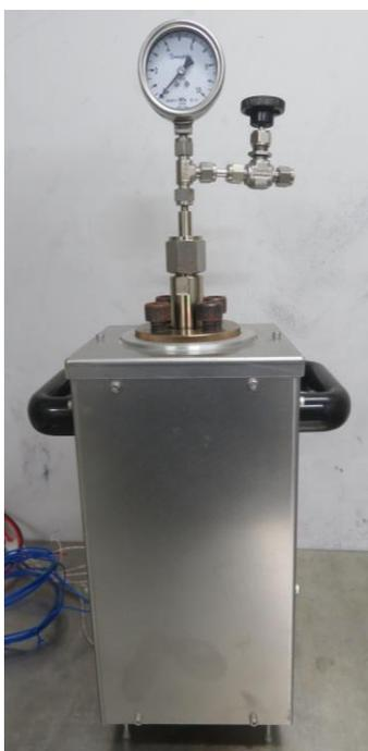
0.5L 小型圧力容器、加熱炉の外観
