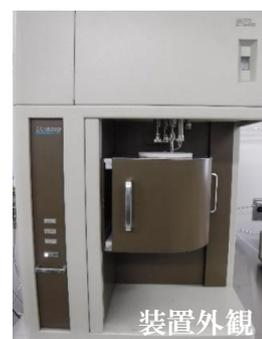
④ 解析（金属表面積、金属分散度、比表面積、細孔分布）
