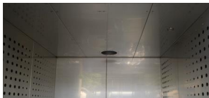
装置上部排気孔および熱電対挿入口
