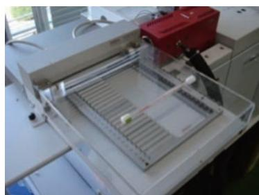
写真9 加熱脱着装置TDS3 GERSTEL社製
