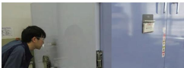
写真10 2m<sup>3</sup>チャンバーを用いた官能評価
