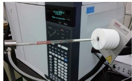
Step 2 スイッチングデバイスにより目的のニオイが検出される時間だけ流路を切り替えて目的のニオイ成分だけを捕集管に濃縮する
